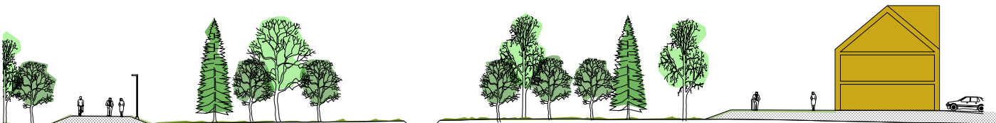
Sektion B. Skala 1:500. Principsektionen visar en modifierad variant av tvåstegsdiket. Där befintlig naturmark utgör den översvämningsbara platån i tvåstegsdiket. Utfyllnad för fastighetsmark och gång- och cykelbana utgör invallningen av den översvämningsbara ytan.
